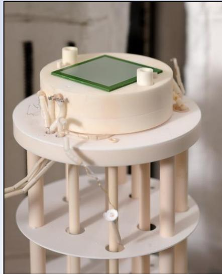
Testgehäuse zur Charakterisierung von SOFC-Einzelzellen
